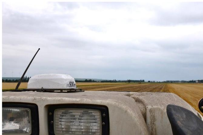
Abbildung 4: Case Nav-900 GNSS-Empfänger, die Stabantenne gehört zum Radio des Traktors
