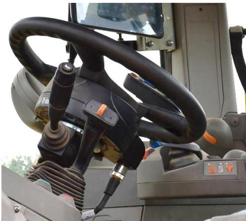
Abbildung 3: EZ-Pilot Lenkrad
